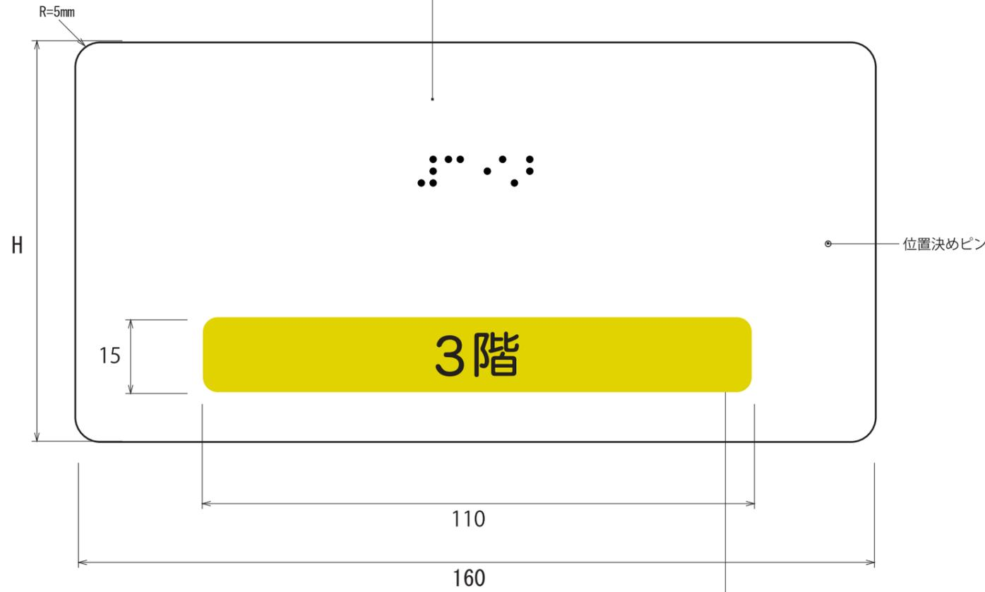
透明ポリカーボネイト曲面加工 インクジェット・ダイレクト裏印刷
